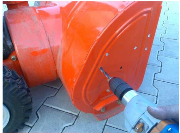
1) Povolte šrouby \* na středním dílu rámu. Na kolíky aretace nasadte na obou stranách frézy plocháče. Rám nastavte vodorovně do potřebné šíře a vyznačte otvory pro vrtání
